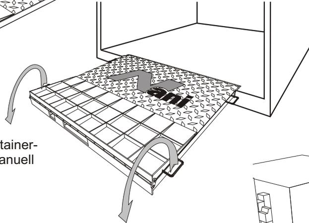
Der Auffahrkeil der Container-Überladebrücke wird manuell abgeklappt.
