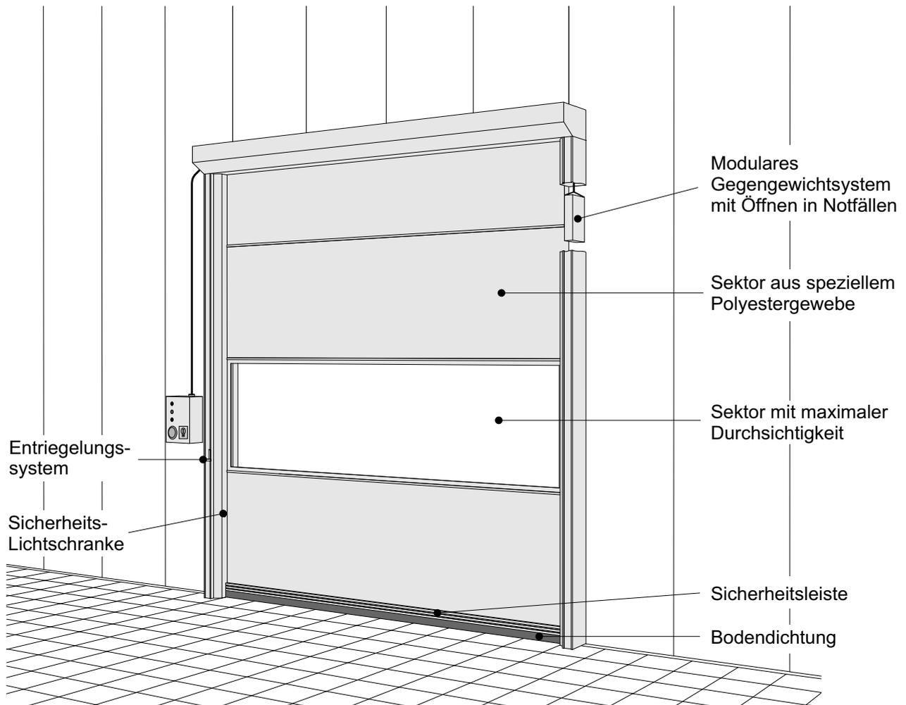
**Das Nani-Schnellauftor mit austauschbaren Sektoren** ist eine elegante Lösung für Betriebe, in denen der Stapler-Verkehr wegen der häufigen Durchfahren den Einsatz von schnellen Toren verlangt.
